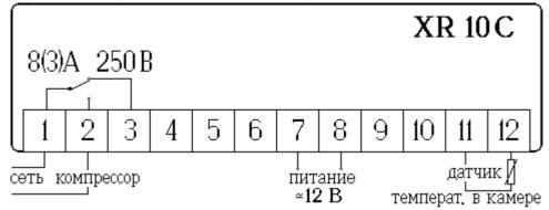
Схема подключения прибора XR10C с источником питания 12 В (пост./перем. тока) и управляющим реле с максимально допустимым током 20A:
